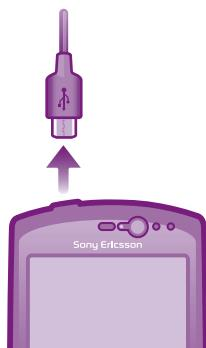
**!** Při odpojování kabelu dávejte pozor, aby nedošlo k ohnutí konektoru.
