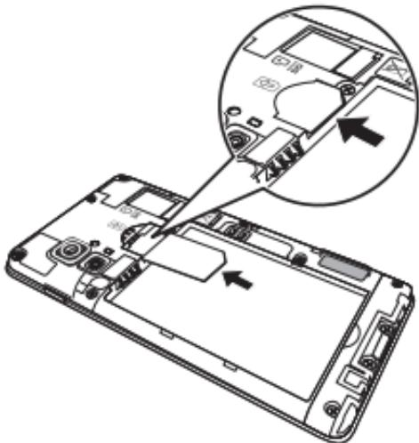
**3** Batériu vložte na miesto, zarovnajte pritom zlaté kontakty telefónu a batérie a batériu (1) jemne zatlačte, aby zapadla do príslušnej polohy (2).
